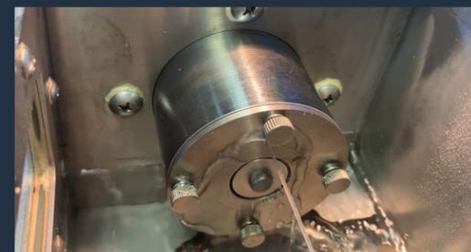
Dari hasil uji karakteristik pencucian dengan air, dapat dilihat jumlah Kobelco Multi-Purpose Grease setelah pengujian lebih banyak dan tidak terbuang oleh air jika dibandingkan dengan grease merk lain.
