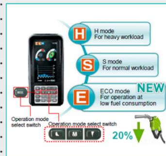
Inovasi Kobelco telah menciptakan “Mesin Konstruksi Ramah Lingkungan” yang memainkan peran penting pada beragam lokasi konstruksi di seluruh dunia. Performa unit ini meningkatkan produktivitas pada semua jenis proyek berkat kekuatan, daya tahan, dan efisiensi bahan bakar yang luar biasa, dengan konsumsi bahan bakar yang efisien, dengan mempunyai tiga pilihan mode kerja yaitu H, S, dan E (Eco Mode), Kobelco SK130-10E adalah excavator canggih yang mencapai Efisiensi yang lebih besar.
