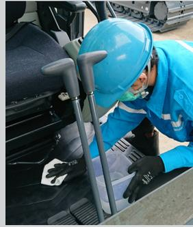
Untuk membersihkan bagian bawah *cabin*, cukup gunakan kain lap yang telah direndam dengan air yang dicampur dengan sabun atau dengan disinfektan. Dengan catatan, *cabin operator* tidak boleh diguyur menggunakan air secara langsung. Karena pada bagian bawah *cabin* terdapat banyak komponen kelistrikan yang tidak boleh kena air.
