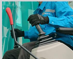
Dalam mengoperasikan tuas *attachment unit* selalu gunakan sarung tangan. Sarung tangan ini berfungsi untuk mencegah tangan kita kontak langsung dengan benda disekitar kita.
