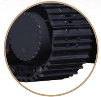
**M**enyesuaikan jenis *track shoe* atau landasan roda bagian luar pada *excavator* dengan kondisi tanah dapat memperpanjang masa penggunaan *undercarriage*.
