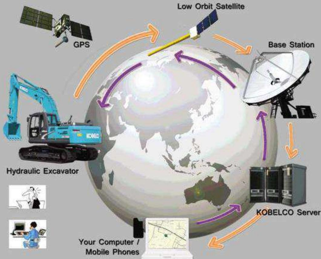
Kobelco dengan bangga memperkenalkan produk excavator terbarunya yaitu Acera Geospec Super-X, yang kini telah dilengkapi dengan Sistem Monitoring IT yang dapat memonitor dan mengetahui data kerja mesin seperti waktu operasi, lokasi, konsumsi bahan bakar, bahkan hingga ke status perawatan mesin. Data-data tersebut dapat diperoleh dengan mudah melalui akses internet.
